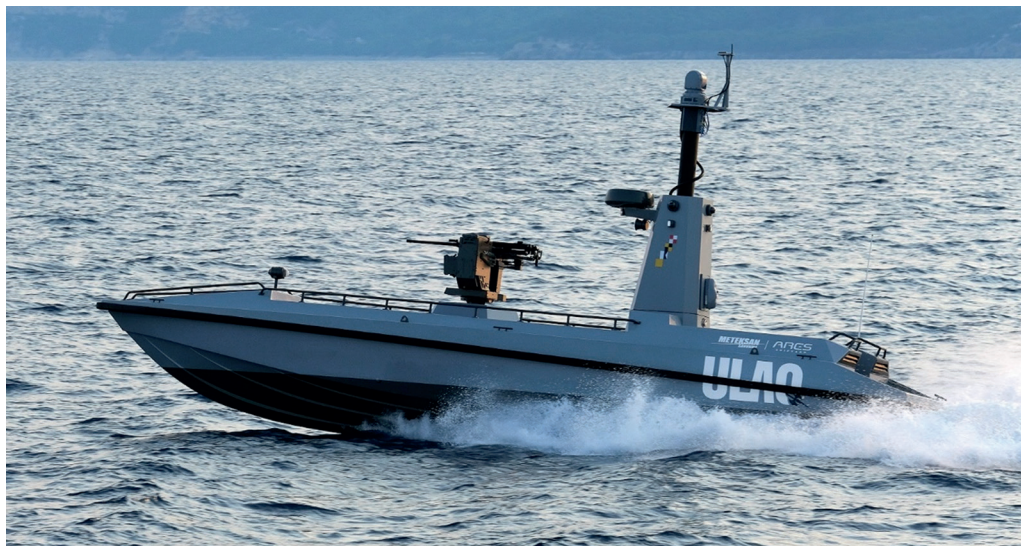
179. ábra: A török haditengerészet első, 12,7 milliméteres távirányítású géppuskával felszerelt ULAQ USV-je Forrás: Naval News Staff 2022
