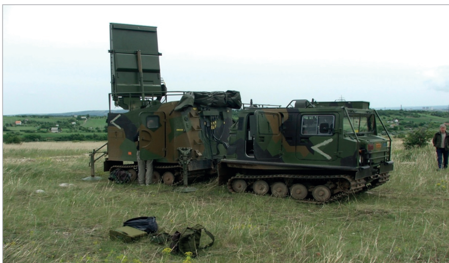
15. kép: Arthur tűzeszköz-felderítő lokátor Forrás: https://en.wikipedia.org/wiki/ARTHUR_(radar)
