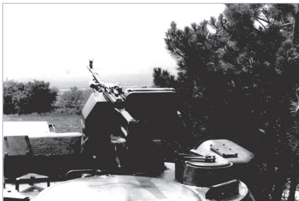
12. kép: IV14 harcjármű a kombinált parancsnoki figyelőműszerrel képes éjszakai körülmények között is a célfelderítésre és a tűzmegfigyelésre
