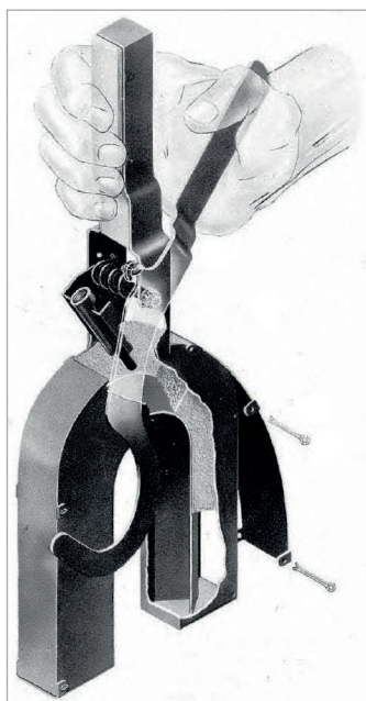
36. ábra: Amerikai Mark I kábelrobbantó töltet
