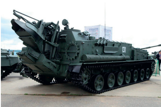
17. ábra: GMZ-3 típusú önjáró aknarakó
