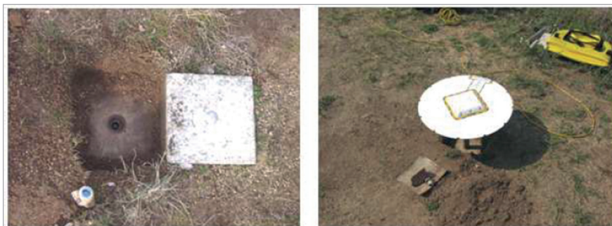
3.10. ábra: Csavarmenettel ellátott háromdimenziós pontjel és a rézrúdra erősített GPS-antenna ([1] 9. p)
