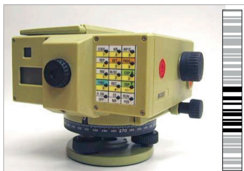
6.16. ábra: A Leica NA 2000 digitális szintezőműszer és a hozzá tartozó bárkódos lécek egy szakasza [9]
