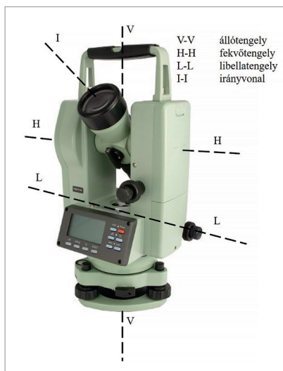
4.6. ábra: A teodolit tengelyei (a szerző szerkesztése [7] felhasználásával)
