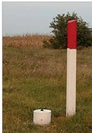
3.8. ábra: Szintezési gomb és kő (az ábra a szerző szerkesztése; fotó: [1] 3. p)
