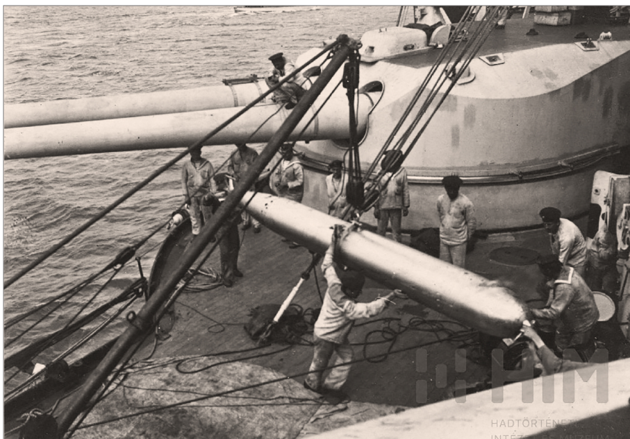
4.2. kép. Torpedó beemelése a Zrínyi csatahajó fedélzetére
