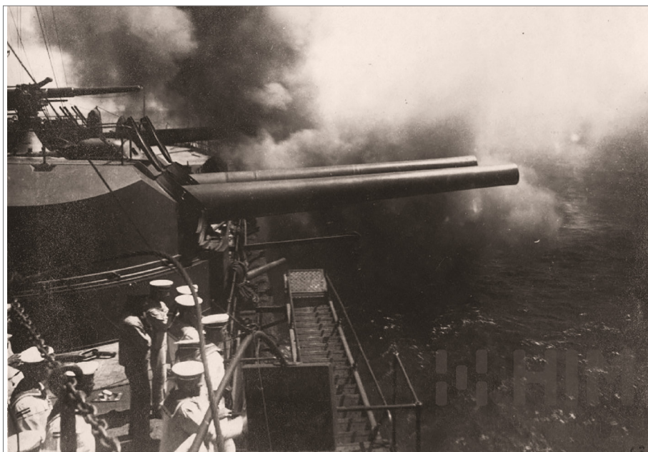
4.7. kép. A Zrínyi csatahajó 24 cm-es ágyúí tüzelés közben
