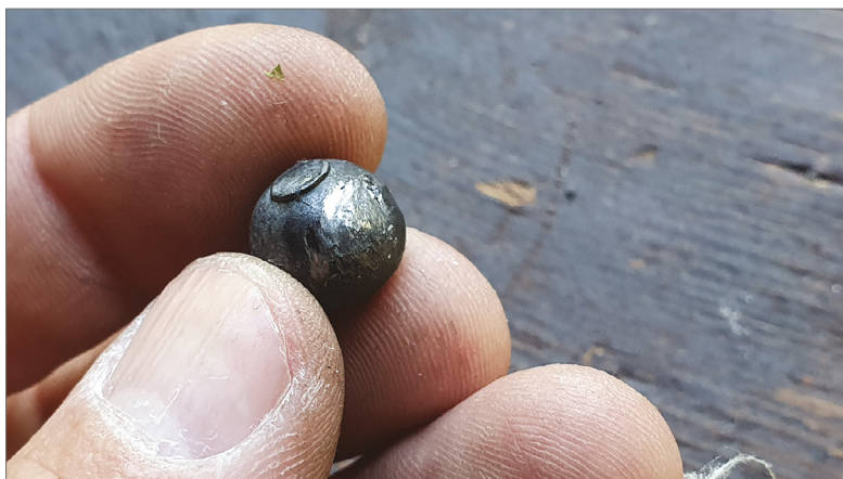
8.20. kép. A cső koptatásának nyomai a pisztolygolyón
