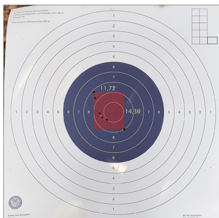
8.16. kép. A keréklakatos pisztoly szórásképe 10 m-en golyóöltettel
