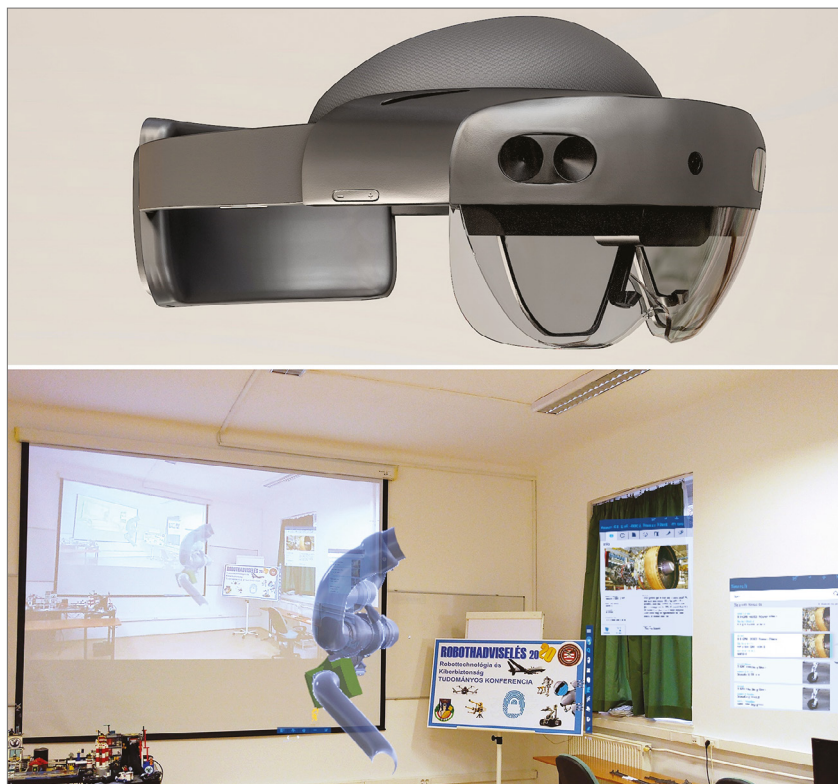
9.18. kép. HoloLens 2 MR-szemüveg és a szemüveg kijelzőjén látott kép digitális tartalommal
