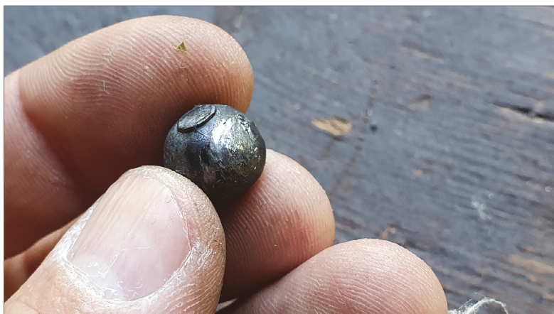
8.20. kép. A cső koptatásának nyomai a pisztolygolyón
