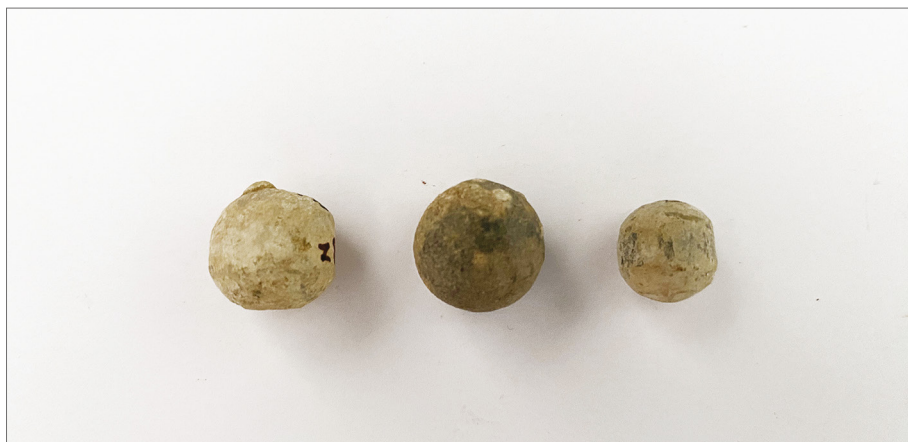
8.14. kép. A cső koptató hatásának nyomai kilőtt, puha közegben visszanyert muskétalövedéken Forrás: a szerzők szerkesztése
