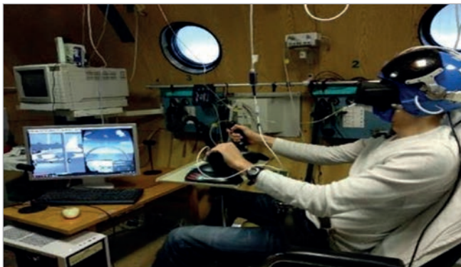
2. ábra: NIRS és VR integrációja barokamrai szimulált felszállás közben
