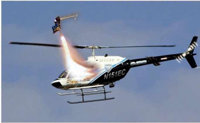
15. a) ábra: UH-1 típusú helikopter kísérleti vészelhagyása katapultüléssel, a fékeződő forgószárnylapátok között
