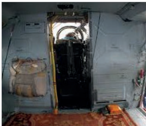
5. ábra: Szovjet Mi-24 típusú helikopter deszant terében – a pilóta üléséhez vezető „folyosótól” balra – alkalmazásra előkészített állapotban látható a fedélzeti technikus PN-58 típusú mentőejtőernyője.
