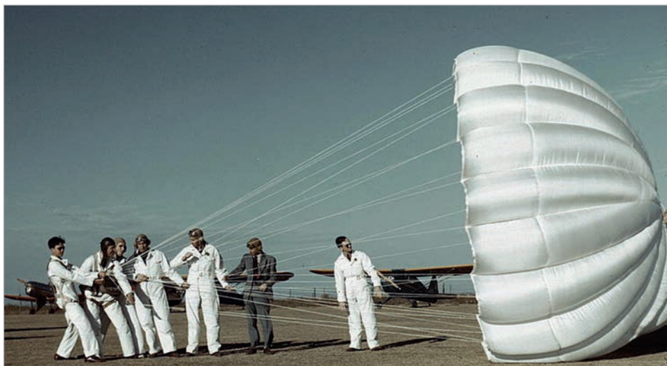
1. ábra: Ritka pillanat: szemléletes gyakorlati oktatás az ejtőernyő-kupola földet érést követő, talajszerű hatására bekövetkező belobbanásának megszüntetésére az alsó tartózsínórok behúzásával. Figyelmet érdemel, hogy ez egy hasi kialakítású, Irvin-féle nyitási rendszerű pilóta-mentőejtőernyő [Meacham repülőtér, Fort Worth, Texas, USA, 1942.]
