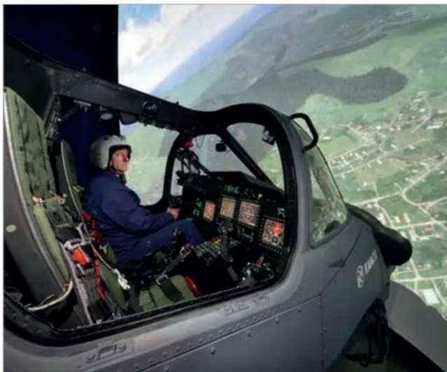
13. ábra: PSz-40 típusú mentőejtőernyő, valamint a K-37-800M típusú komplex mentőberendezés a Ka-52 típusú harci helikopter szimulátorába beépítve
