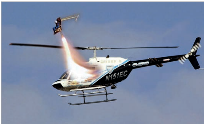
15. a) ábra: UH-1 típusú helikopter kísérleti vészelhagyása katapultüléssel, a fékező forgószárnylapátok között
