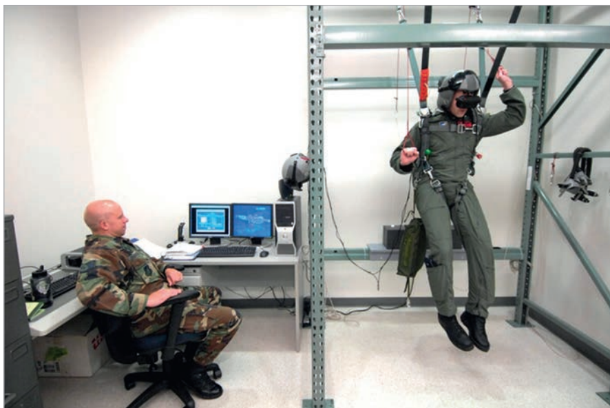
22. ábra: Napjaink amerikai repülő-hajózáinak egyik mentőejtőernyős szimulátora (Hickam Air Force Base, Hawaii, USA). A képzés valóság-hűségét jól szemlélteti az USAF-nál rendszeresített BA-22 típusú személyi mentőejtőernyő-hevederzet, valamint az ahhoz rögzített, a pilóta oldalán lógó egyéni túlélőcsomag is Forrás: Virtual technology enhances training for aircrews. 2006. Online: www.af.mil/News/Article-Display/Article/129527/virtual-technology-enhances-training-for-aircrews/
