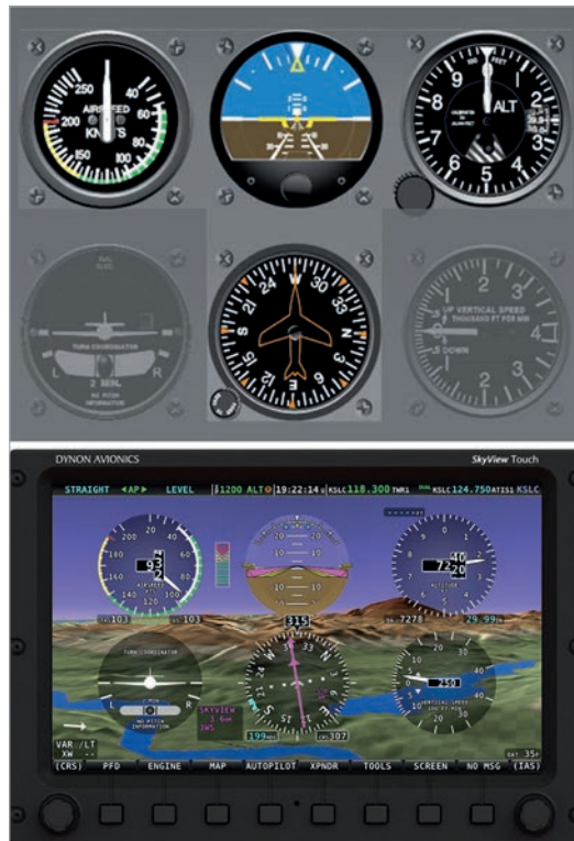
11. ábra: T-elrendezésű műszerek
