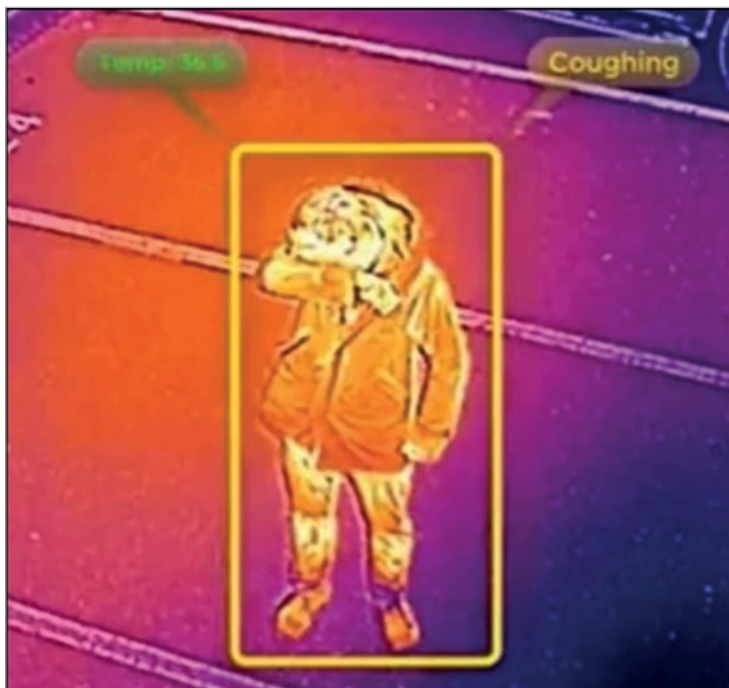
8. ábra: A drón a kamerájával a lázas állapotot és a köhögést is azonosítani tudja
