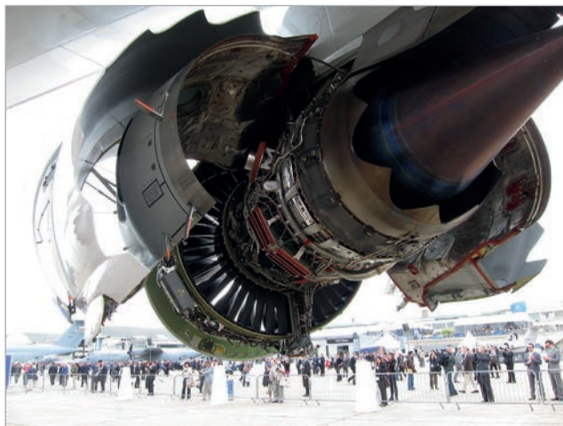
27. ábra: GENx-hajtómű a Boeing 747-8I prototípusában
