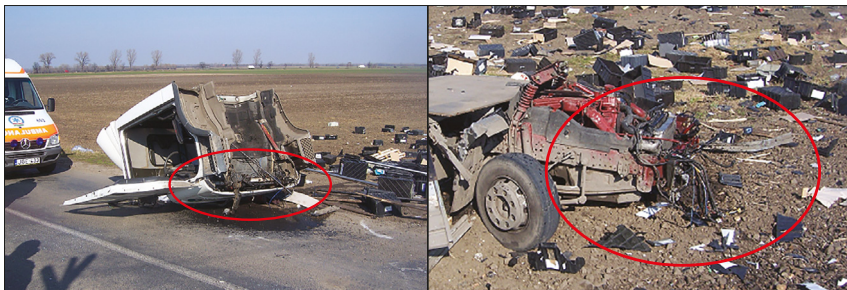
16.1. ábra. Közúti baleset során a sérült járműből az úttestre, valamint az út melletti szántóföldre kifolyt hűtő-, kenőfolyadék (pirossal jelölve) és a szétszóródott rakomány
