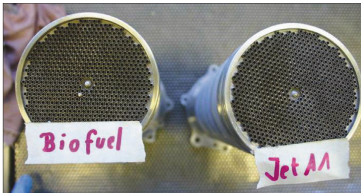
9.6. ábra. Biokerozinnak kitett hőcserélő elszíneződése
