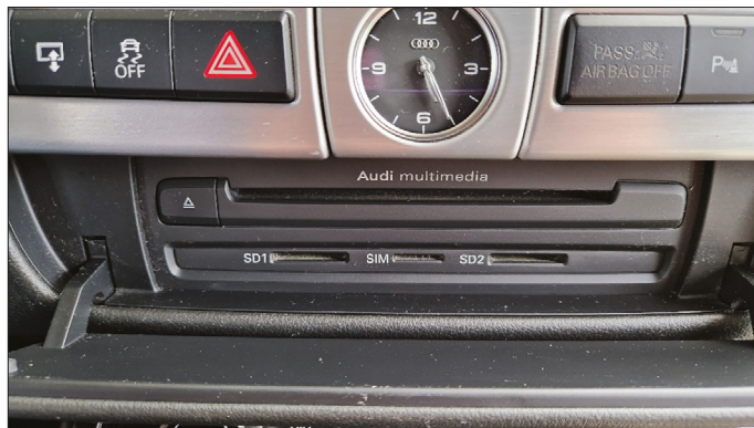
6.3. ábra. Egy jármű multimédia-egysége USB- és SIM-csatlakozási lehetőséggel
