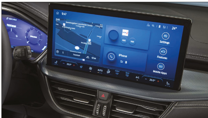
6.5. ábra. Egy jármű multimédiás fejegysége, az egyik leggazdagabb adatforrást biztosító elem a szakértői vizsgálatokhoz
