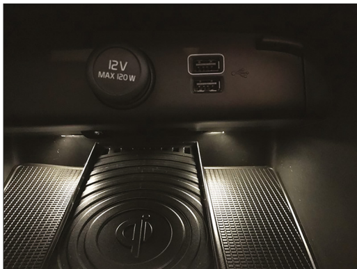
6.1. ábra. USB-csatlakozási lehetőség a jármű középkonzolyjában
