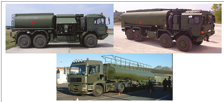
9.5. ábra. ÜTG-10-RÁBA H-25 (jobbra), ÜTG-18-MAN HX 32.440 (balra) és ÜTSZFP-35 MAN TGA 33.480 (középen) típusú üzemanyagtöltő és -szállító gépkocsik Forrás: PAPP 2011
