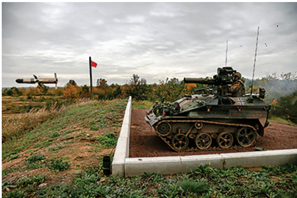
6. ábra: A Wiesel-1 légideszant páncélozott harcjármű TOW páncéltörőrakéta indítócsővel felszerelt páncélvadász változata
