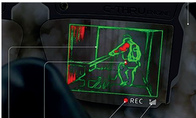
4. ábra: A Qwake Tech futurisztikus, AR-tartalommal ellátott sisakja és a tűzoltó által látott kép füstben, rossz látási viszonyok között
