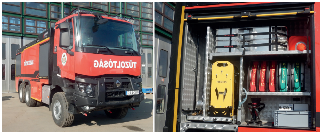
1. ábra: Az új Heros Aquarex S10 típusú vízz szállító a BM Heros budapesti üzemcsarnoka előtt és a rá máházott tömlőcsomagok elhelyezése a jobb hátsó máhaterben
