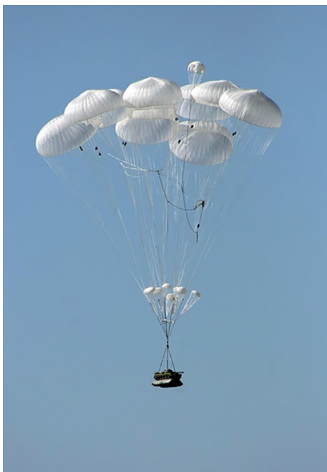
12. ábra: A 2S25 Sprut légideszant könnyű harckocsi teher ejtőernyős ledobása
