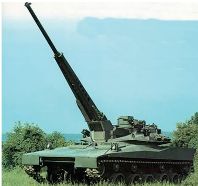
18. ábra: A HSTV(L) légi szállítású harckocsi gázturbinával és alacsony sziluettű toronnyal, illetve ARES-löveggel
