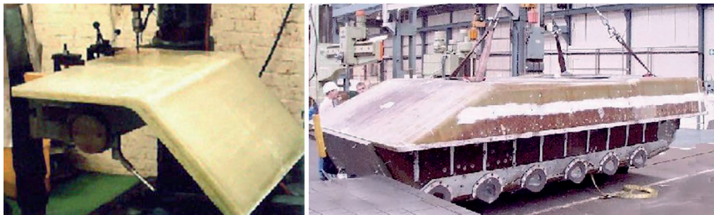
13. ábra: A Vickers ACAVP kompozit szerkezeti elemei
