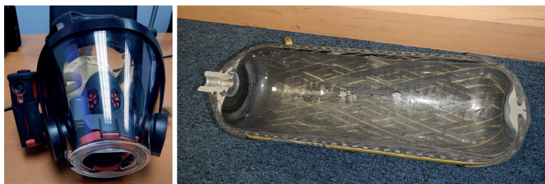
6. ábra: Hőkamerával és belső monitorral felszerelt légzőálarc és egy félbevágott, teljesen kompozit kivitelű sűrített-levegős palack
