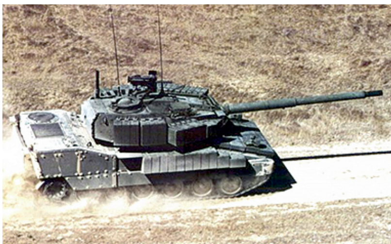
21. ábra: Az XM8 AGS páncélzati blokkokkal NATO Level III szinten védett
