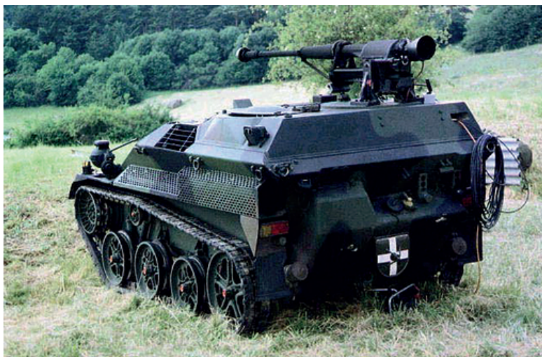
9. ábra: A Wiesel-1 RMK-30 típusú, hátrasiklás nélküli löveggel szerelt géppágyús változata
