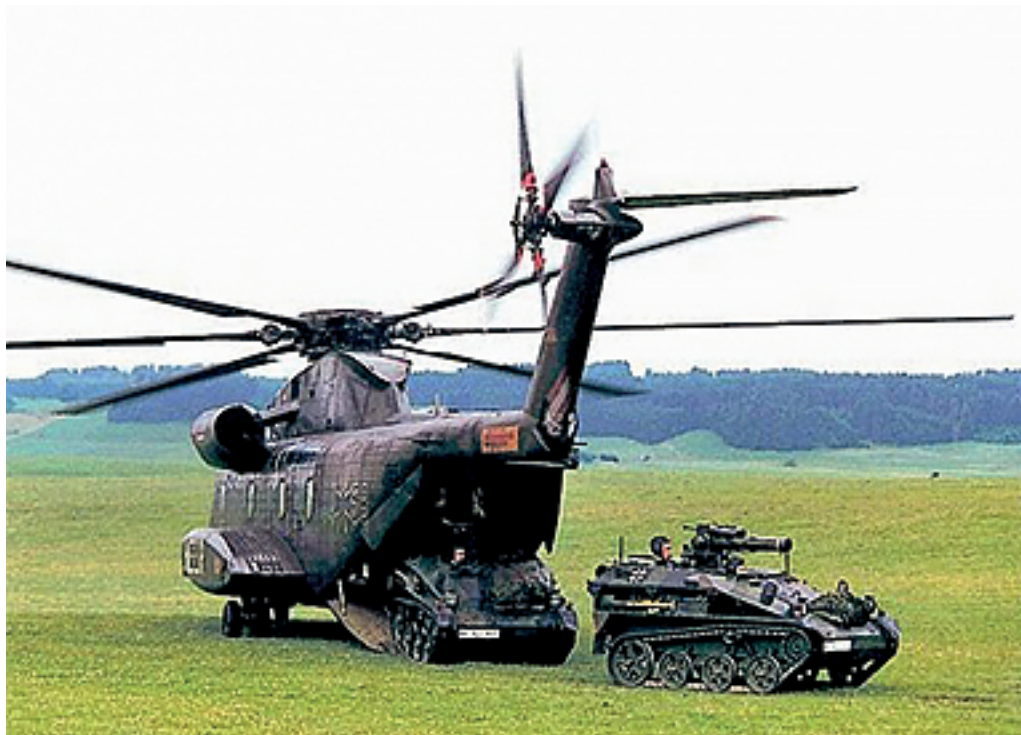
7. ábra: Párban alkalmazott rakétás és gépágyús Wiesloch légideszant harcjárművek deszantolása helikopter belső térből
