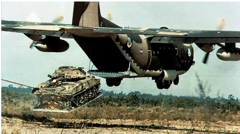
5. ábra: M 551 Sheridan könnyűharcocsi kis magasságú ejtőernyős deszantolása C-130 típusú közepes szállító repülőgépből
