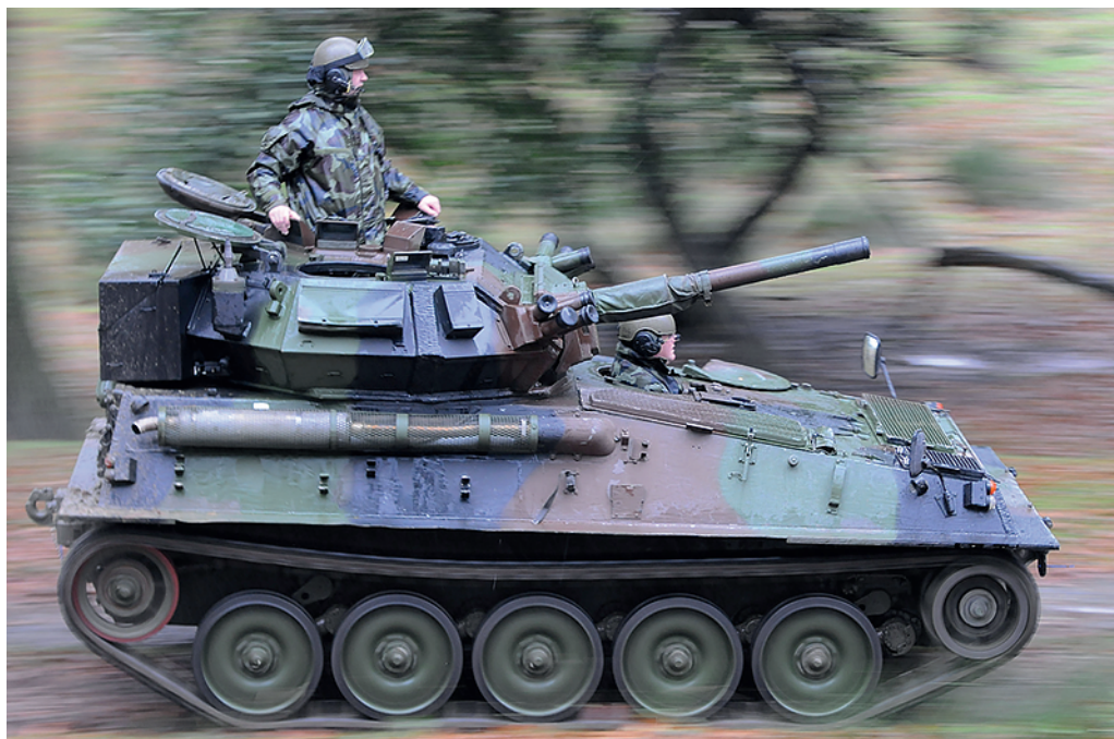
2. ábra: Scorpion könnyű légideszant harckocsi 76 mm-es löveggel
