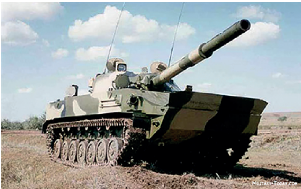
11. ábra: A 2S25 Sprut légideszant harckocsi 125 mm-es löveggel
