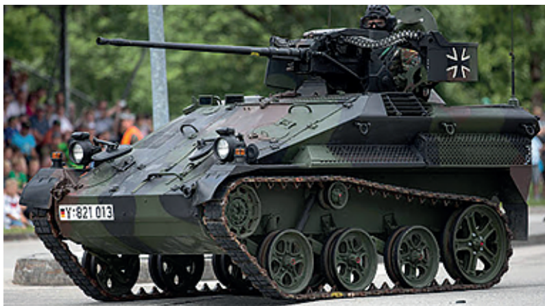
8. ábra: A Wiesel-1 légideszant páncélozott harcjármű géppágyús változata
