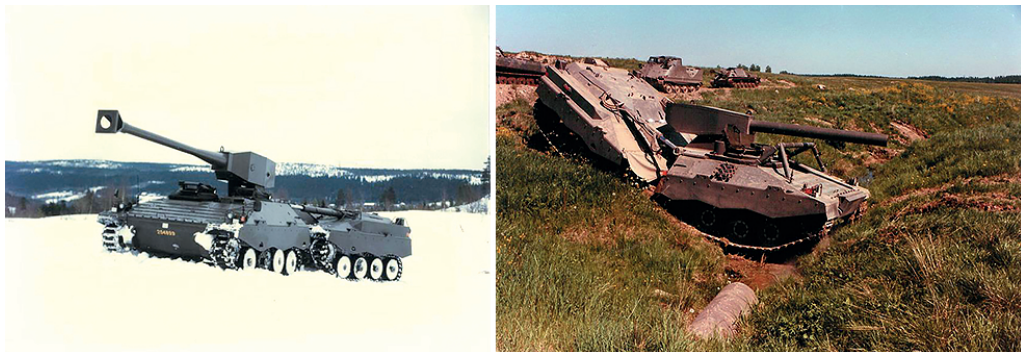
15. ábra: Hägglunds UDES XX-20 osztható járműkonstrukciójú harcjármű
