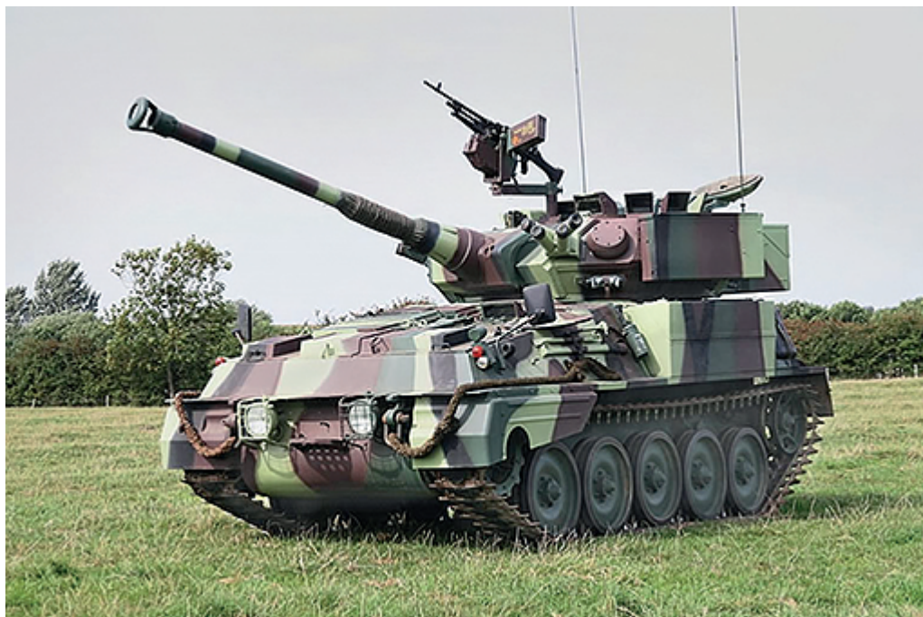
3. ábra: Scorpion könnyű légideszant harckocsi 90 mm-es löveggel
