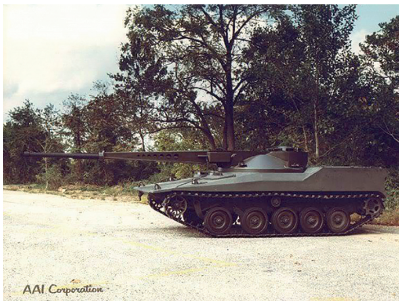
19. ábra: Az AAI RDF/LT kísérleti légideszant harcjármű második változata, 1 fős toronnyal, 3 fős személyzettel
