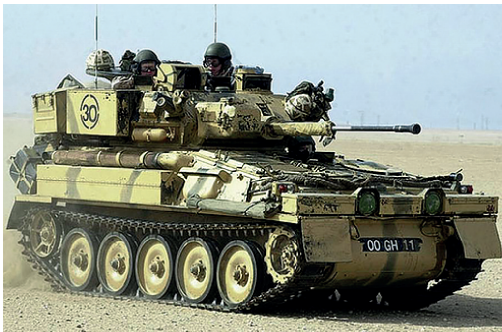
1. ábra: Helikopterrel szállítható és teher ejtőernyővel ledobható FV–107 Scimitar felderítő harcjármű Forrás: http://elfnet.hu/images/haditechnika/harcokcsik/fv107/fv107_felszeres.jpg
