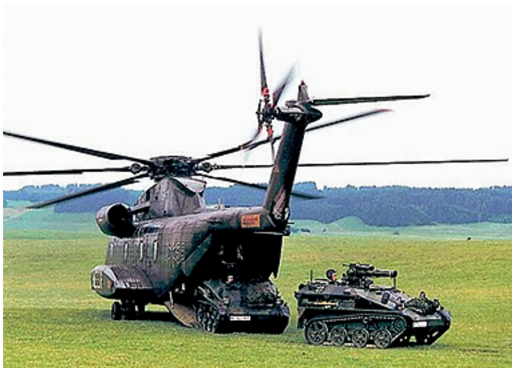
7. ábra: Párban alkalmazott rakétás és gépágyús Wiesel légideszant harcjárművek deszantolása helikopter belső térből
