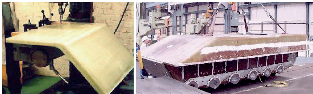
13. ábra: A Vickers ACAVP kompozit szerkezeti elemei
