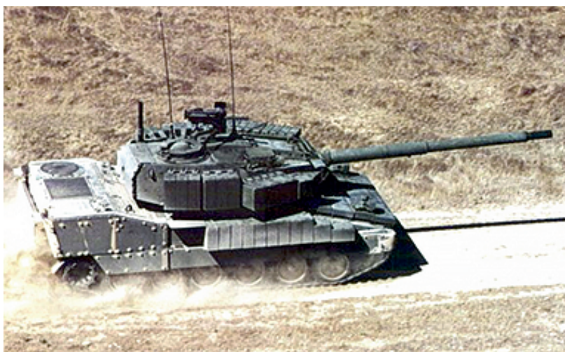
21. ábra: Az XM8 AGS páncélzeti blokkokkal NATO Level III szinten védett
