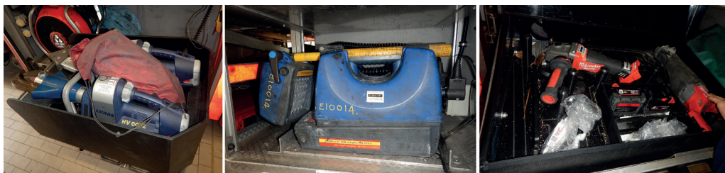
4. ábra: Akkumulátoros telepről működő elektromos eszközök (feszítő-vágó berendezés, mobil kárhely-megvilágító és kézi kisgépek) egy angolai gépjárműfecskendőn
