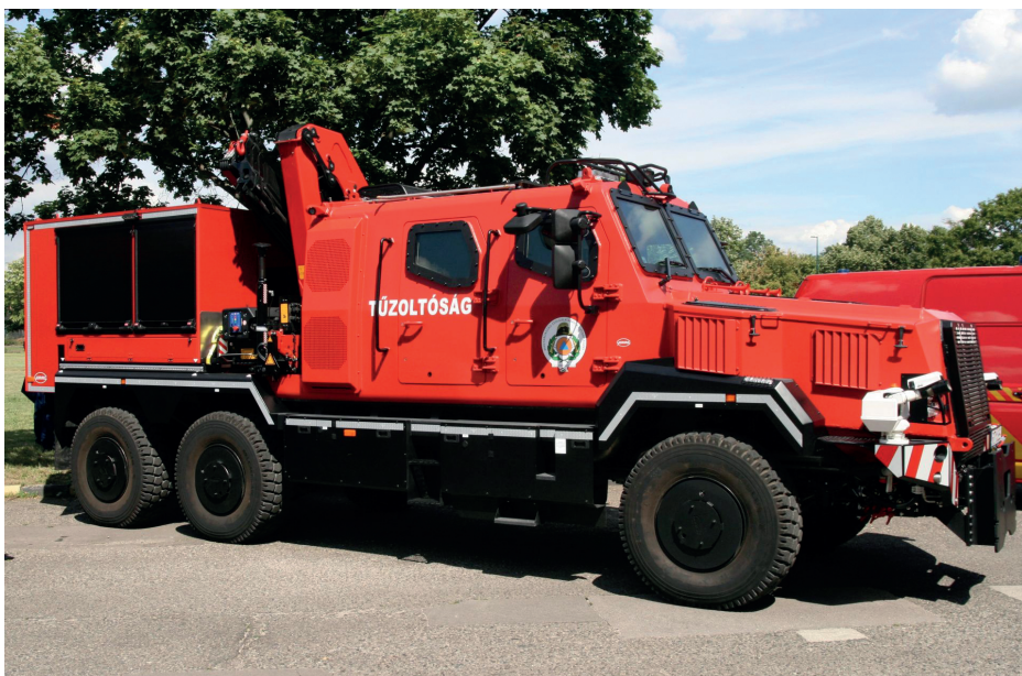
3. ábra: A Komondor, RDO 4336 MPV többcélú tűzoltójármű műszaki mentő cserefelépítménnyel Forrás: www.katasztrofavedelem.hu/29/hirek/240637/uj-jarmuvek-tobb-mint-egy-milliard-forintert
