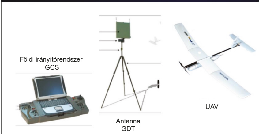
5. ábra. A pilóta nélküli légijármű-rendszer fő elemei
