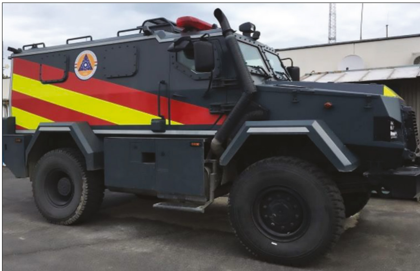
16. ábra. Sugárfelderítési célokra is alkalmazható, sugárnyékolt szállító jármű
