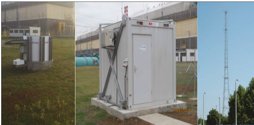
12. ábra. SODAR-rendszer (balra és középen), meteorológiai torony (jobbra)
