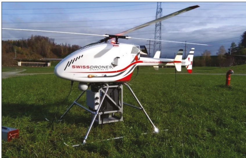
17. ábra. Izotópszelektív sugárfelderítésre képes drón
