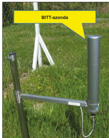
9. ábra. A környezeti állomáson kívül elhelyezkedő BITT-szonda
