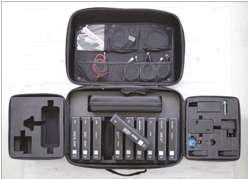
1. ábra. Szakértői eszközkészlet modern járművek szakértői vizsgálatához
