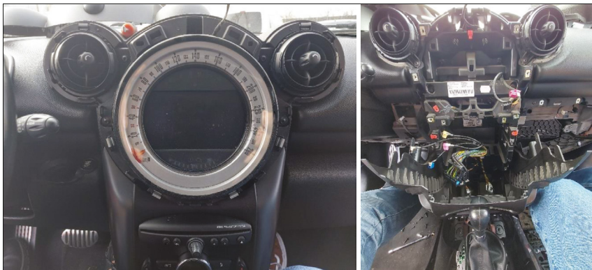
2. ábra. Mini Cooper műszerfalának szétszerelése a fejegységhez való hozzáférés érdekében
