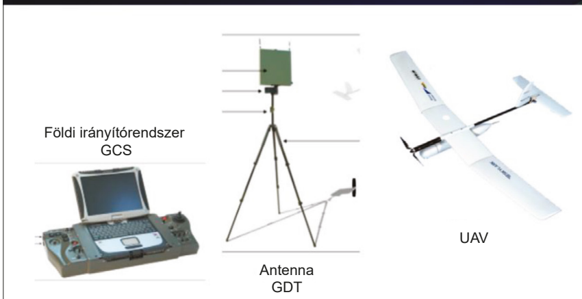
5. ábra. A pilóta nélküli légijármű-rendszer fő elemei
