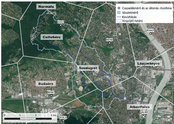
7. ábra: A Határ-árok vízgyűjtő területe a vízsztintmérő feletti szelvényben és a csapadékmérők Voronoi-poligonjai (műholdkép: bing.com)
