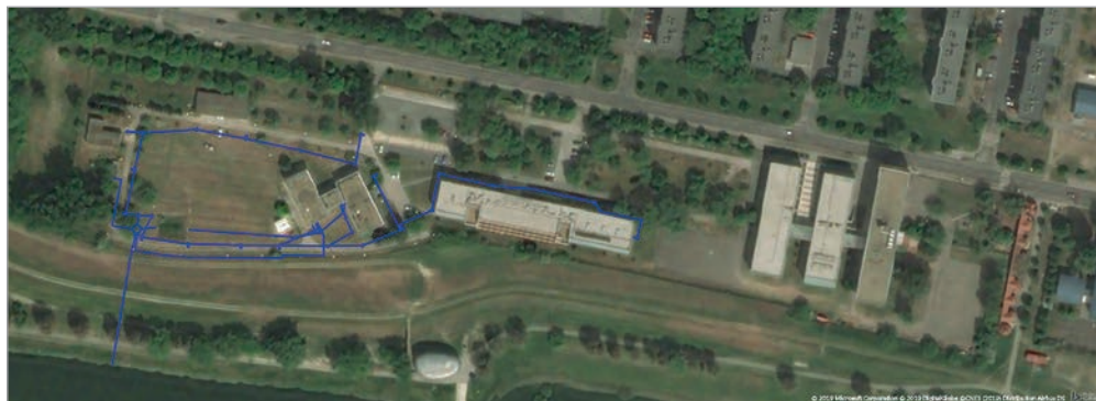
13. ábra: NKE VTK Baja VOB és kollégium esővízgyűjtő csatornázottsága (a szerző)
