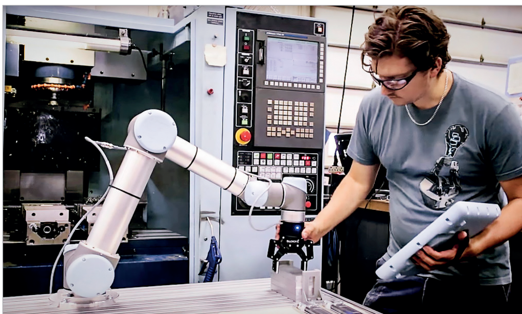
2. ábra: Kollaboratív robot – egy légtérben, a dolgozóval együttműködve segíti, gyorsítja és teszi biztonságosabbá a munkavégzést a precíziós vagy fizikailag nehéz munkafolyamatok során
