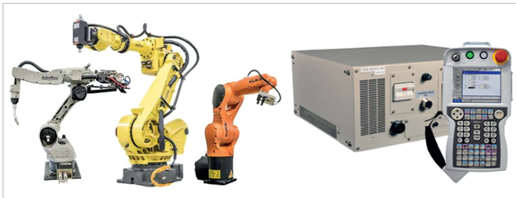
7. ábra: Jellemző ipari robotkarok, vezérlő és programozó konzol
