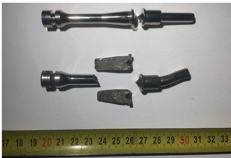
21. ábra: A gázátömlő furat áthelyezése miatt túlterhelődött és tönkrement gázdugattyú
