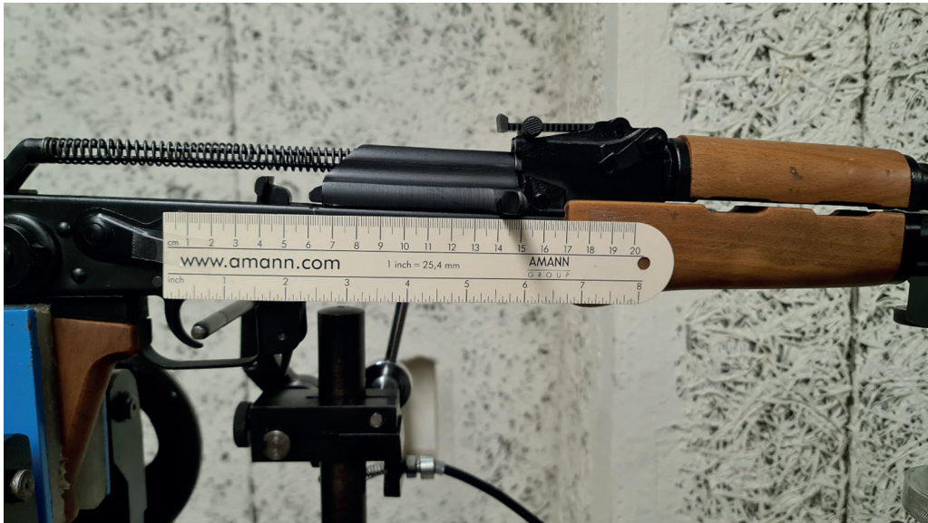
22. ábra: A zármozgás filmezéséhez befogott és preparált AMMSZ gépkarabély
