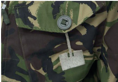
14. ábra: Microstrip-textilantenna vezetőképes fonalból
