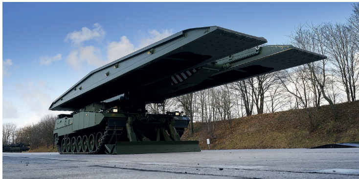
6. ábra: Leopard 2 Leguan hídvető harckocsi 26 méteres rohamhíd telepítése közben
