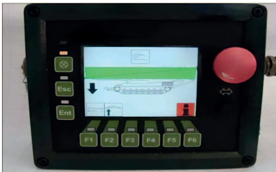
3. ábra: A Leopard 2 Leguan hídvető harckocsi kezelőpanele.
