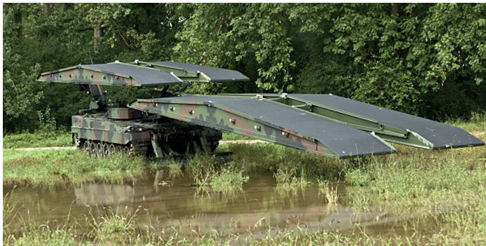
7. ábra: Leopard 2 Leguan hídvető harckocsi 14 méteres rohamhíd telepítése közben
