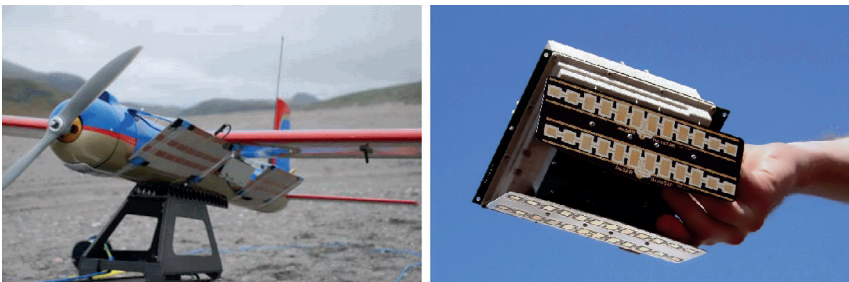
19. ábra: SAR-microstripantennarács UAV-eszközökre
