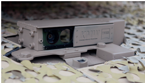
4. ábra: A Leopard 2 harckocsisaládban használt kamerarendszer
