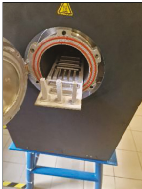
4.3. ábra. Különféle próbatestek nyomtatás utáni hőkezelése a szinterkemencében Forrás: a szerzők felvétele
