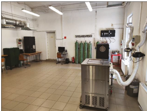
4.2. ábra. ADAM-technológiájú 3D fémnyomató laboratórium: nyomtató, mosó és szinterkemence, háttérben a gázellátó rendszer
