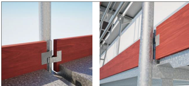
6.8. ábra. A 3D-s megvalósulási részletterr az állványról
