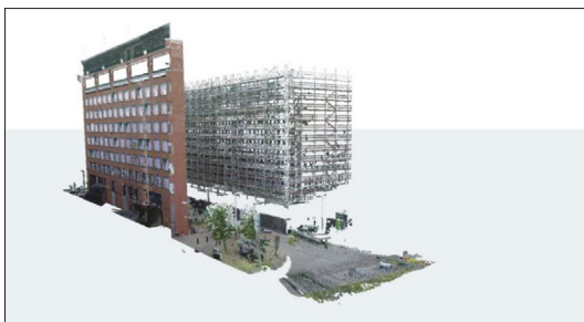
6.6. ábra. A 3D-s pontfelhő az állványról
