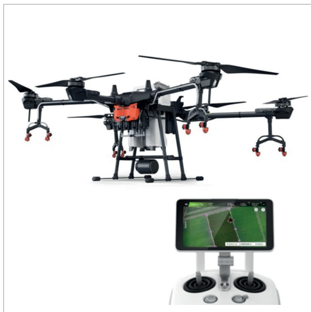
2. ábra: Mezőgazdasági permetező drón (kvad-/hexa-/oktakopter)
